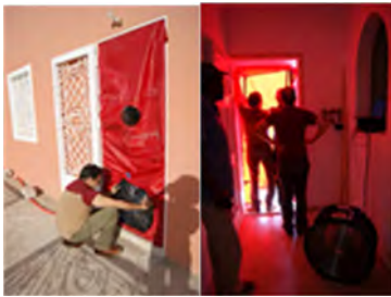
Blower Door Tests
