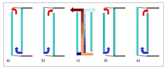
Figure 3-5 AIF flow path: a) EA; b) SA; c) RAF; d) OAC; e) IAC
