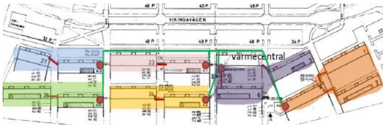
**Figure 58.** District heating network retrofit with 6 smaller substations. Source: Prime Project AB (2016): Kv Eddans pilotus – energi. Stadsdelsförnyelse avkvarteren Eddan 1&2 och Havamal 1&2, pilot. Lund: Prime Project AB.
