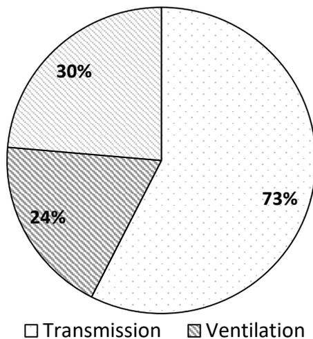
**Figure 56.** Heat loss distribution of the pilot dwellings. Source: Prime Project AB (2016): Kv Eddans pilotus – energi. Stadsdelsförnyelse avkvarteren Eddan 1&2 och Havamal 1&2, pilot. Lund: Prime Project AB.
