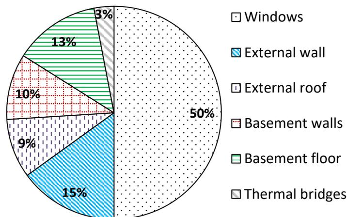
**Figure 57.** Heat losses from transmission for the pilot dwellings. Source: Prime Project AB (2016): Kv Eddans pilotus – energi. Stadsdelsförnyelse avkvarteren Eddan 1&2 och Havamal 1&2, pilot. Lund: Prime Project AB.
